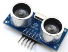
Cảm Biến Siêu Âm HY-SRF05 dùng để nhận biết khoảng cách đến vật cản (4)
