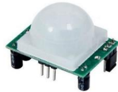
Cảm biến chuyển động PIR (HC- SR501): Phát hiện chuyển động của các vật thể phát ra bức xạ hồng ngoại. (7)
